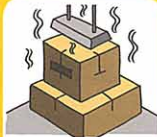
22- Stockage trop haut qui touche les lampes ou les aérothermes.
