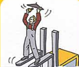
27- Personne sur fourche d'un chariot élévateur pour changer une lampe.
