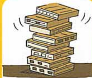
10- Empilement de palettes trop haut.
