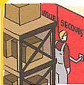
15- Racks devant issues de secours.
