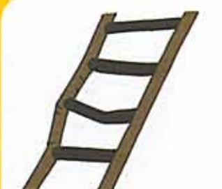
28- Échelle pas droite, en très mauvais état.
