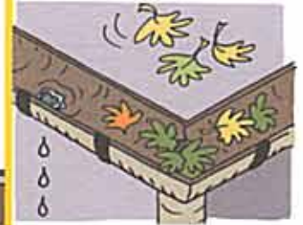
8- Chéneaux bouchés par des feuilles / fuites non-traitées.
